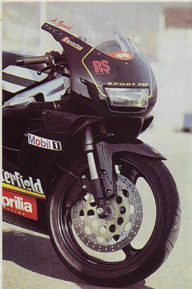
Prednji plavajoči zavorni kolut meri v premeru 320 mm
