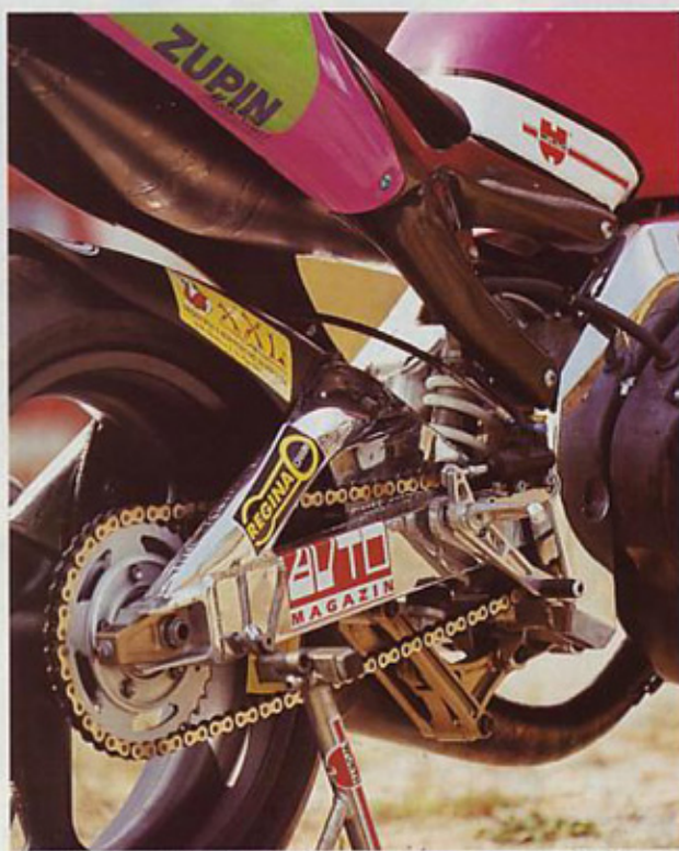
Zadek: asimetrične vilice, ročičje sistema APS iz lahke litine z blažilnikom znamke White Power, lahko magnezijevo kolo.
