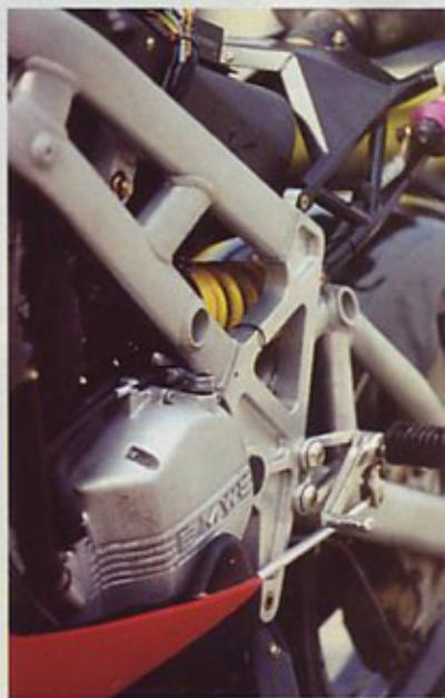
lepu motocikla, pomeni, da vodno hlajeni enovaljnik s štirimi ventilimi v glavi izkašlja 48 KM pri 6500 vrtljajih v minut. Bimota sicer pripravlja (za dirkalno rabo) zamenjavo dveh Mikunijevih uplinjačev premiera 33 mm s kompletom elektronike za vžig in vbrizg goriva, toda prirastek moči ne bo večji od 10 KM.
