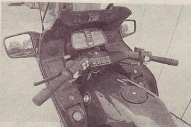
Notranjost učinkovitega aerodinamičnega oklepa: odlično izkoriščen prostor z uporabnimi dodatki. V celoti mehko obloženo krmilo povečuje varnost.
