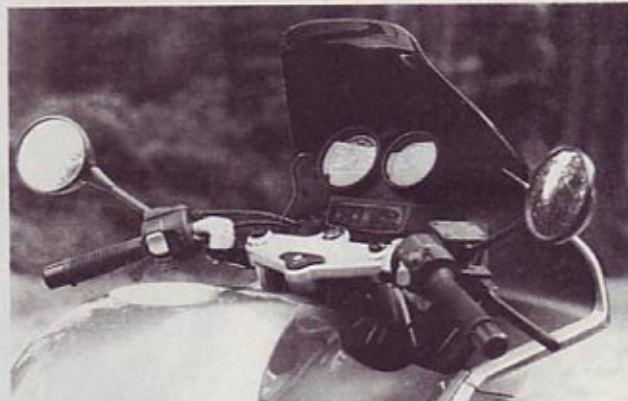
Standardna oprema: malce premajhna merilnika hitrosti in vrtljajev, pod njima signalne lučke. Skopo.
