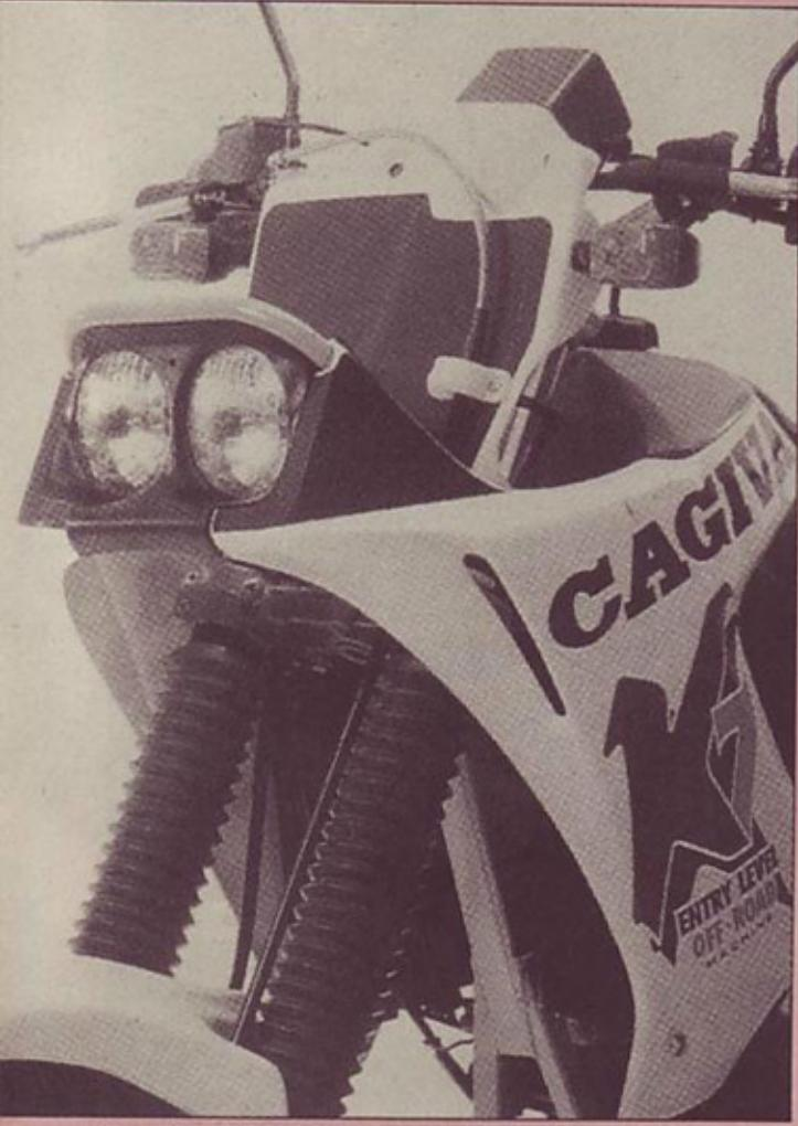
Nenavadno: nizek dvojni žaromet objemata oplati, ki zakriva vodni hladilnik in sta spojeni z rezervoarjem.
