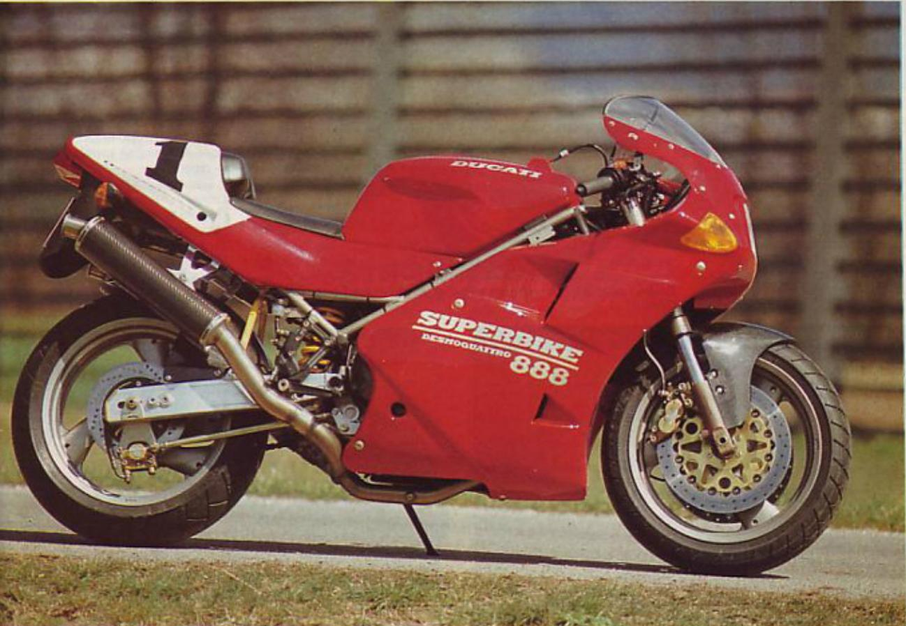
in lahka konstrukcija. Motor je nosilni del okvirja. Skozi ohišje motorja so vpete zadnje nihajne, aluminijaste vilice! Na okvir se opirajo prek centralnega blažilnika (znamke Ohlins), vpetega v vitko ročičevje. Prednji del pa se opira na vilice sistema upside - down japonske izdelave Showa, z oznako "special" in kraki premera 41 mm. Ševeda, kako-vostno vzmetenje je nastavljivo v vseh smerih delovanja.
