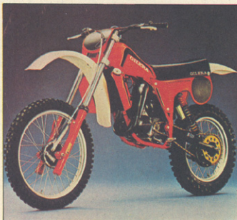
Gilera 125 C1 je dolga 2180 mm, široka 840 mm, visoka 1210 mm, sedež pa je visok 920 mm. V rezervoar gre 6,7 l goriva. Gume so dimenzij 3,00-21/4,00-18
