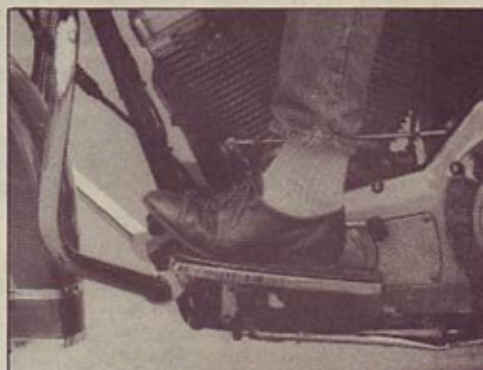
Unikatne nožne opore: zajetna ploščad z v gumo vpeto oblogo proti vibracijam; prestavna ročica, ki jo upravljajo prsti in peta, varuje čevlje
