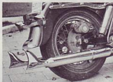
Ribji rep za dušilce, na zadnjem kolesu originalni kolut s plavajočo čeljustjo
