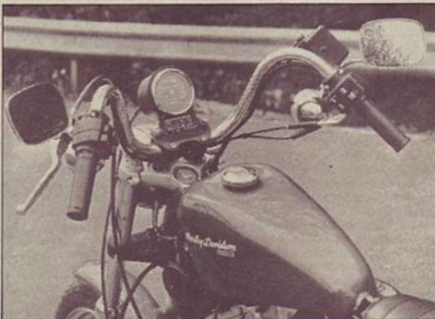
Krmilo je elastično vpeto, ročice in stikala zelo priročna, pred očmi le en instrument in štiri kontrolne lučke
