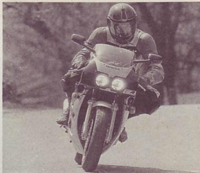
Prednji del: teleskopska vilica, širokokanalno kolo z nizkopresečno radialno, par kolutov premera 296 mm.
