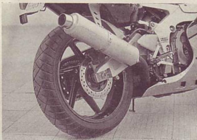
Zadek: Nihajka, oblikovana kot galebje krilo, aluminijast dušilec izpuha, širokokanalno kolo.
