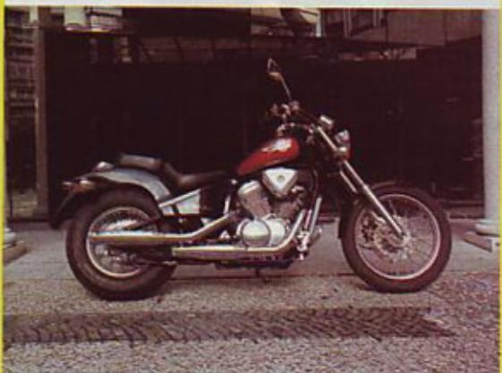
**Motor:** dvovaljni - štritaktarni - tekočinsko hljeni - ena odprtina gred v glavi - po trije ventili na valj - vrtina in gib  $75 \times 66$  mm - prostornina 583 kubikov - kompresija 9,2 : 1 - največja moč 28,6 kW (39 KM) pri 6.500/min - največji navor 48 Nm pri 3.500/min - uplinjalč 2 x tip CV 34 mm - elektronika CDI - dinamo 310 W - akumulator 12V/8Ah
