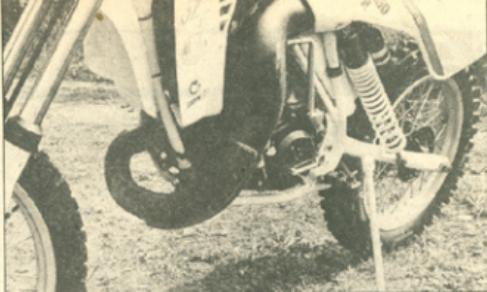
Izpuh je na novo zakriven, ovir je v višini valja spremenjen, ročica za zagon motorja je daljša, plastična obroba hladilnika usmerja zrak
