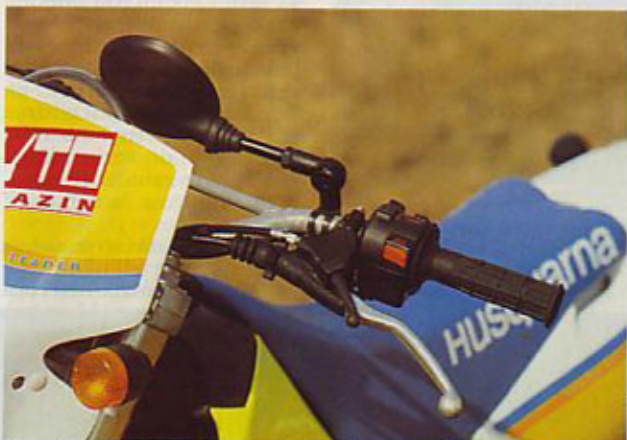
Krmilo: povsem preklopno vzvratno ogledalo, znana stikala, pripravne ročice
