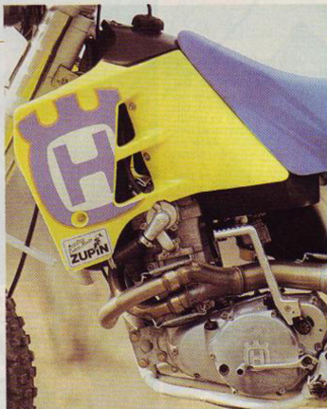
Motor: preprost, trpežen, uporaben; izpušna cev je izdelana iz nerjaveče kovine in se končuje v dveh dušilnih hrupa
