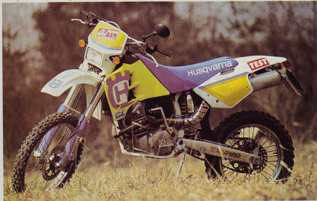
Motor: preprost, trpežen, uporaben; izpušna cev je izdelana iz nerjaveče kovine in se končuje v dveh dušilnih hrupa
