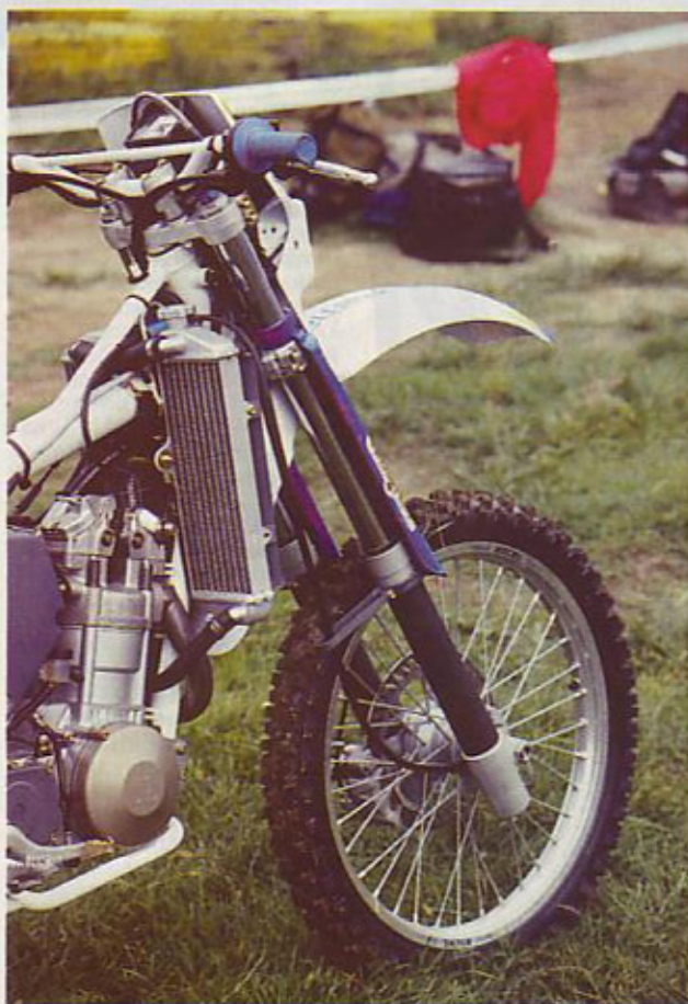
Klasične teleskopske vilice so spet boljše od sistema upside-down
