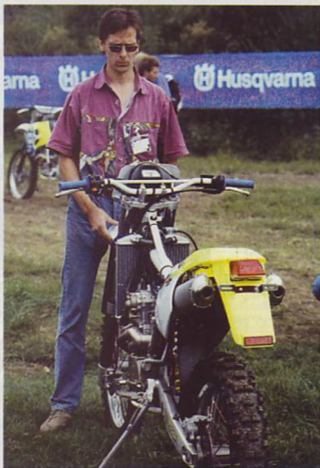
Enojni zaprti cevni okvir, predtek 112 mm, širina motocikla 810 mm.
