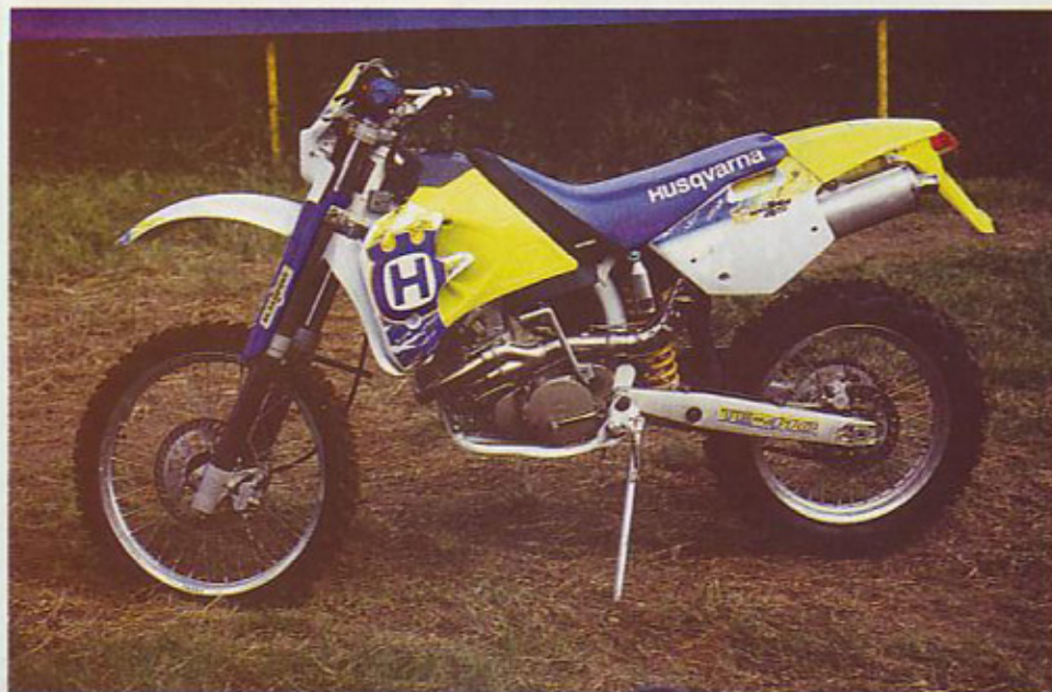
TE 410: medosna razdalja 1495 mm, dolžina motocikla 2180 mm, višina sedeža od tal 885 mm, najmanjša razdalja od tal 368 mm, posoda za gorivo 9,1 litra, suha teža 116 kg.
