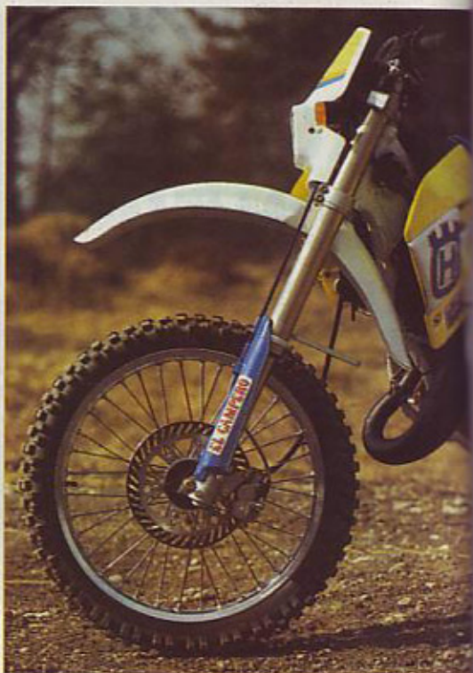
Prednji del: akront aluminijasti kolesni obroč, zmogljiv in lahek kolot, dovolj solidne vilice
