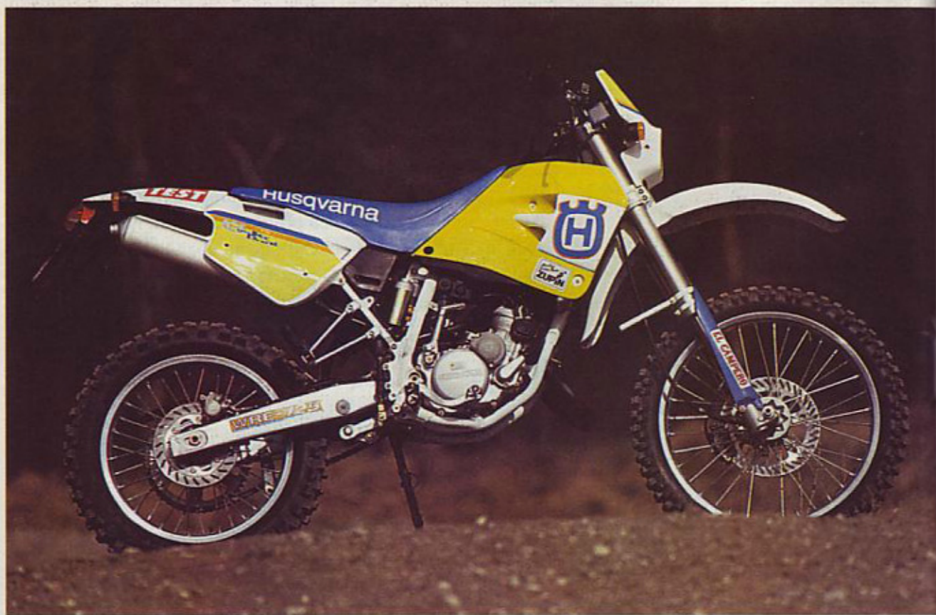
Prednji del: akront aluminijasti kolesni obroč, zmogljiv in lahek kolot, dovolj solidne vilice
