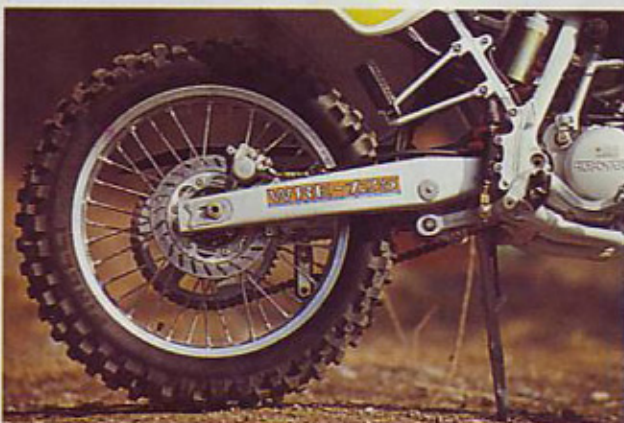
Zadek: močne nihajne vilice, v ročičevje vpet centralni blažilnik, kolutna zavora
