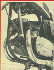
Pod sedežem je akumulator z ostalimi električnimi deli, pod levim pokrovom pa vrečka z orodjem. (ZGORAJ) Prednja zavora je dvojna, vendar pa ni dovolj močna. (LEVO SPODAJ) Jawino srce je dvovaljni dvotaktni motor. Največja moč je 28 KM (SAE). (DESNO SPODAJ)
