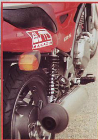
Klasika zadaj: bobnasta zavora in par oljno-vzmetnih blažilnikov.
