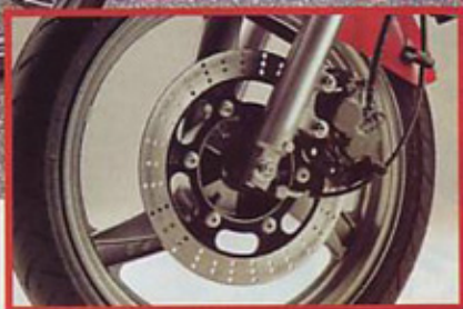
Prednje kolo: zmogljiva, pa ne preostra kolutna zavora.
