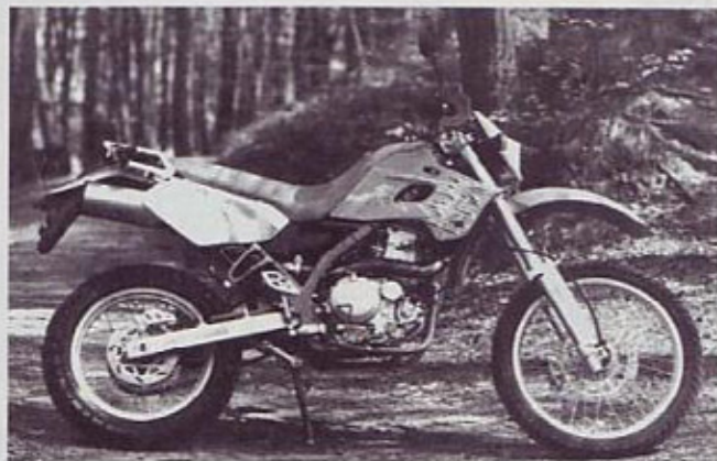
Prednji del: solidno vzmetenje, kolut premera 290 mm
