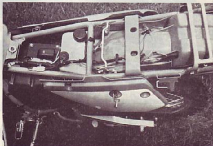
Pod sedežem: zračni filter, rezervoar olja in kličavnica sedeža.
