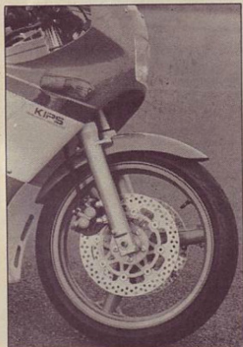
Širokokanalno kolo z gumo 100/70–17; plavajoča koluta odlično zavirata
