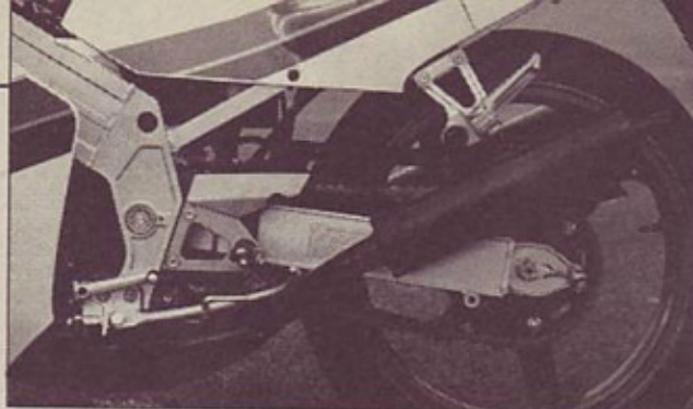
Zadaj guma 130/60-18, odlično pridušeni izpuhi, lepo obdelane nožne opore
