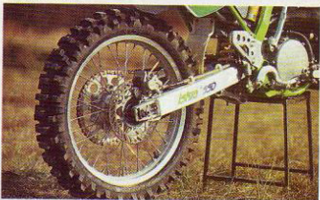
Zadek: aluminijaste vilice s progresivno delujočim vpetjem uni-trak, močnejše tovarniško kolo, zavorni kolot daje dober občutek.
