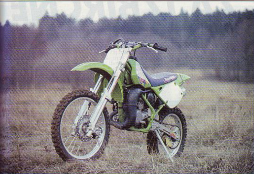
Spodobno vzmetenje s hodom 275 mm spredaj in zadaj
