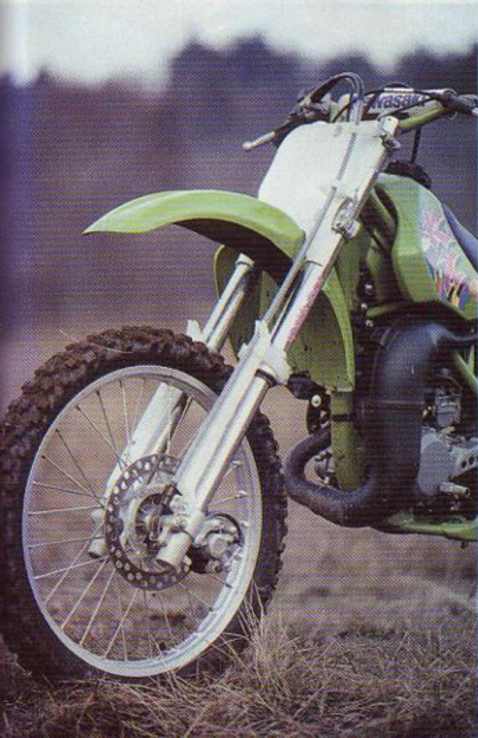
Spodobno vzmetenje s hodom 275 mm spredaj in zadaj
