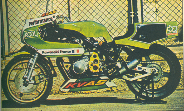
Za prednjim kolesom sta kraka mehničnega anti dive sistema, dvodelen oklep omogoča hitre pristope k motorju, zadnja nihajka je oprta le na en blazilec
