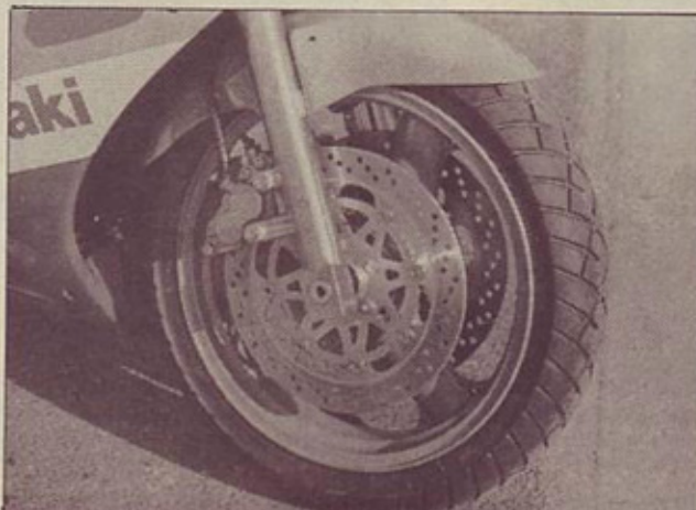
Prednji del: vilica \varnothing 43 mm, koloti \varnothing 310 mm, trikrako širokokanalno aluminijasto kolo
