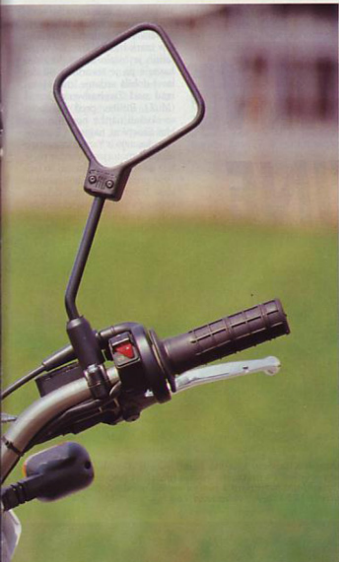
Za masko žarometu: merilnik hitrosti, z jekleno nitjo opletena cev zavorne napeljave, ob ročici plina gumb električnega zaganjalnika
