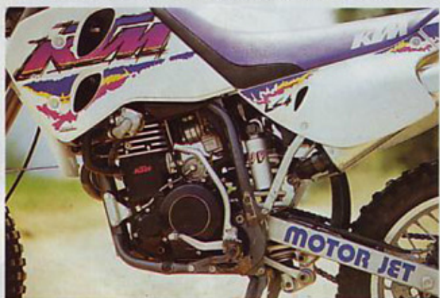
Agregat: en valj, štiri ventili, uporabna moč in prožnost
