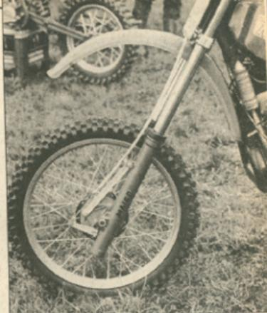
Maico vilica: pnevmatsko hidravlična vilica s kraki Ø 42 mm. Na okvir je pritrjen rezervoar zadnjega Ohlins blažilnika
