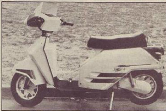
Hitro snemljiv bočni panel, oblikovan iz plastike odpira dostop do motorja
