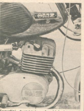
Enovaljni, dvotaktni, zračno hlajeni motor je elastično vpet v odprt cevast okvir.
