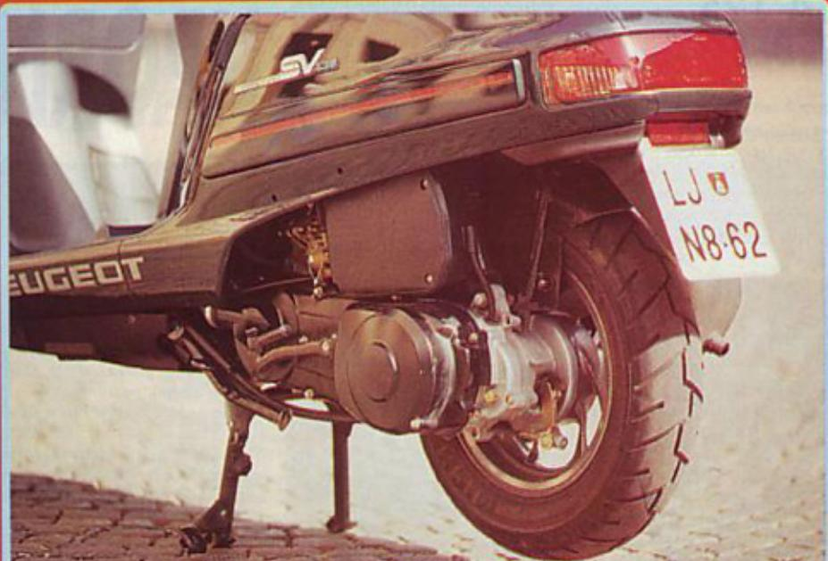
**Motor:** enovaljni - dvotaktni - zračno hlajeni (veronica) - sesanje prek lamelnega ventila - vrtina in gib 55 x 52,4 mm - prostornina 124,5 kubika - kompresija 6,1:1 - največja moč 8,0 kW (11,0 KM) pri 7000/min - največji navor (ni podatka) - uplinjač K-PB 18,4 - neosvinčeni bencin - avtomatska črpalka za dovod mazalnega olja - elektronski brezkontaktni vžig - električni zaganjalnik - nožni zaganjalnik - svečka NKG BP6HS - akumulator 12V 5Ah
