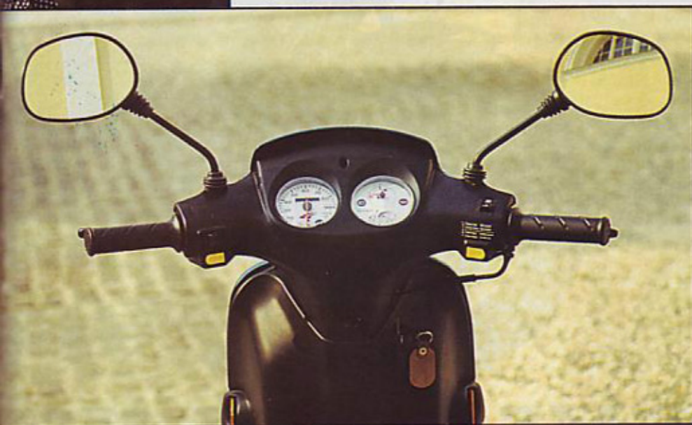
Krmilo prekriva plastika, v katero so vtisnjeni stikala in pregledna merilnika
