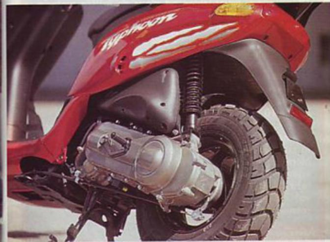
**Motor in prenos moči tvorijo en sklop, oprt na blažilnik**
