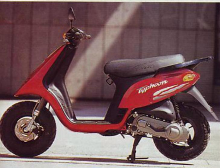
proti sedežu pneata dva močna, iz pločevine oblikovana nosilca. Zadnje vzmetenje: motor s prenosom moči kot nihajni sklop, optre na blažilnik, vpet z leve strani med ohišje prenosa in okvir.
