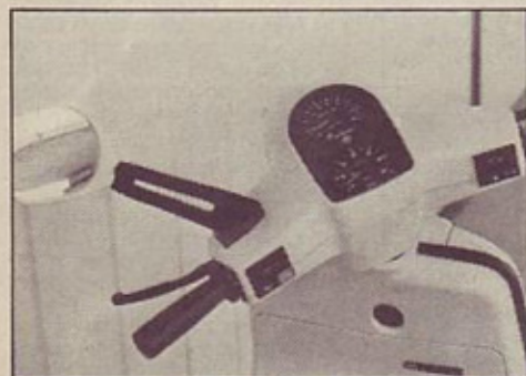
Cosa: vrtljiva je le leva ročica brez sklopa štikal; novo je vzvratno ogledalo; k merilniku hitrosti je prigraven tudi merilnik vrtljajev
