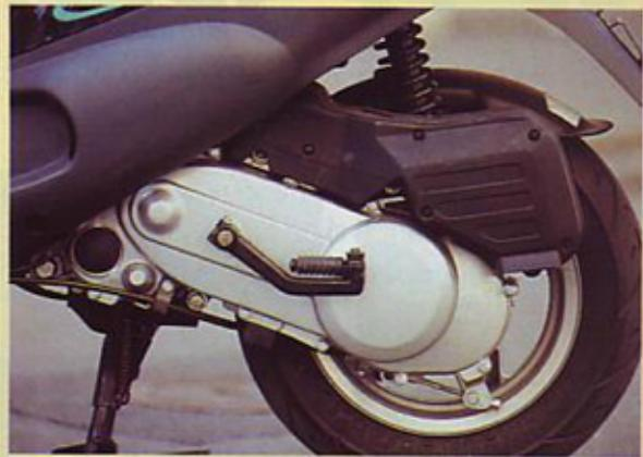
**Motor:** enovaljni - dvotaktni - zračno hljeni z vetrnico - sesanje preko lamelnega ventila v ohišje motorne gredi - vrtina in gib 40 x 39,3 mm - prostornina 49,4 kubika - kompresija 10,9 : 1 - največja moč 2,8 kW (3,9 KM) pri 6750 vrtljajih/min - največji nava 5,4 Nm pri 5500 vrtljajih/min - uplinjač Dell Orto 12 - neosvinčeni bencin - avtomatska črpalka za dovod mazalnega olja - električni zaganjalnik - nožni zaganjalnik.
