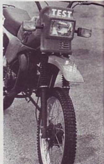
Teleskopske vilice so zaščitene z rebrasto gumo. Smerna kazalca sta elastično vpeta.
