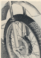
Prednje vilice odlično pobirajo še tako globoke luknje in zelo učinkovito ublažijo dolge in visoke terenske skoke, ki jih Tomosov cross zmore. Kromiran prednji blatnik mladostno in lepotno deluje.
