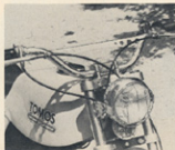
Žaromet z zaslončano in dolgo lučjo je zavarovan s kovinsko mrežico, ki ima dokaj modni nadih. Balanca je ojačana s prečnim nosilcem.
