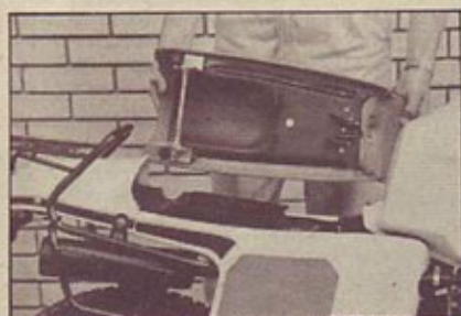
Sedež je mogoče ločiti od motocikla tako, da sprožite nepriročen mehanizem. Pod sedežem je plastično korito za orodje in nekaj drobnarij
