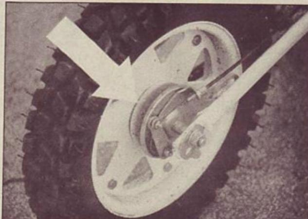
Pregret zavorni boben zadnjega kolesa, netočnost v izdelavi. Kolo samo je izdelano iz dveh jeklenih odprešanih polovic, ki sta med seboj vičjeni
