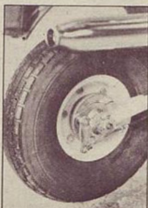
Zadnji zavorni boben – pregrevanje zaradi težko nastavljive zavore
