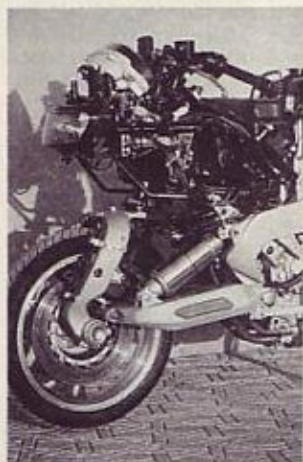
Pod oklepom: nosilna konstrukcija aluminijasta, tanko cevno paličje nosi krmilo in komponente
