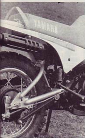
PW 80: cevna nihajna vilica je oprta na centralni blažilnik.
