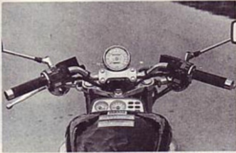
Na obeh: visoko nasajeno krmilo, obilje kroma, merilnik hitrosti z oznakami do 260 km na uro. Ločeno so v sklopu združeni merilnik temperature motorja, merilnik vrtljajev in signalne lučke.
