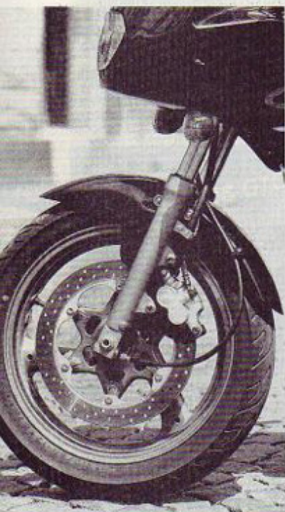
Prednji del: dobro delujoče vilice, lito trikrako kolo in kolot premera 320 mm
