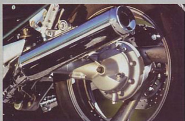
Kardan: nežen kot veriga, ne zahteva pogostega vzdrževanja
