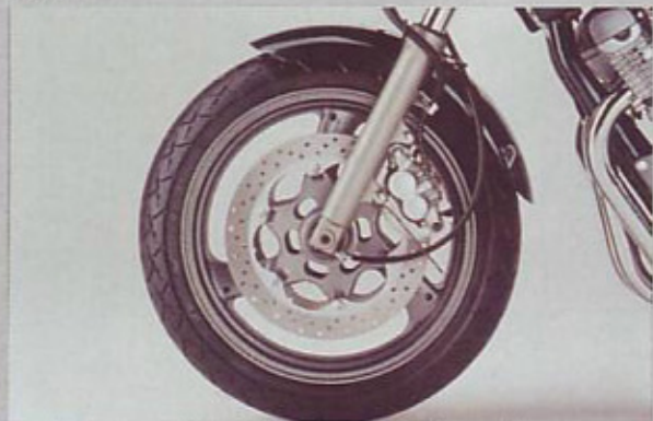
Prednji zavorni komplet: zahteva odločen stisk zavorne ročice
