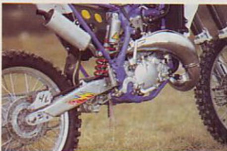
Olajšan okvir iz jeklenih cevi tesno objema motor. Tudi zadnje vilice so olajšane.
