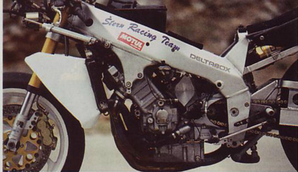
Yamaha YZF 750 SP: serijski okvir deltabox, novo vzmetenje in spremenjena geometrija, zavore PVM in okrepljen motor
