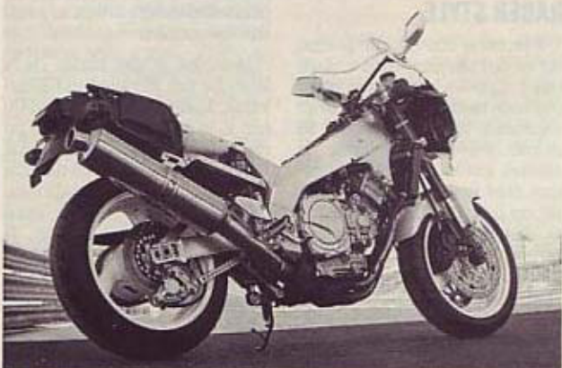
Iz pločevine oblikovan okvir deltabox. Pomožni zadnji del okvirja je vijacen.
