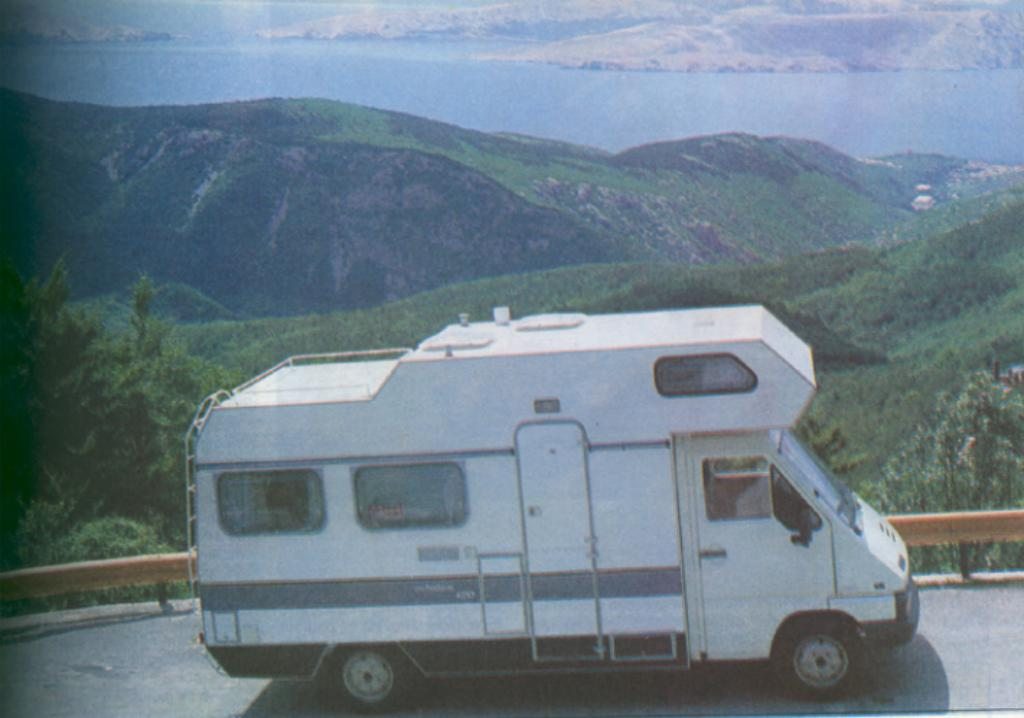
nerazumljivo, da se načrtovalci niso spretneje ognili nosilnemu okviru za kabino in tako zmanjšali ali se povsem ognili veliki reži med streho vozniškega prostora in dnem bivalnega nadstreška. Ravnog ta reža povsem odvečno golta zrak in zavira vozilo, pa tudi boke bi na ta način znižali – v veselje vozniku, kadar zapila veter s strani.
